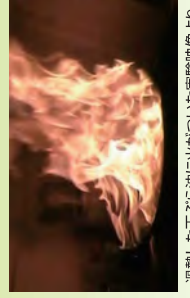
過熱した天板から油に火がついた実験映像より
